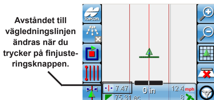
Figur 9-56. Finjusteringsknappen används till att rikta in AB-linjen efter fordonet
