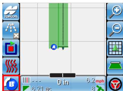
Figur 9-25. Ange punkt B som markerar slutet på raden.
