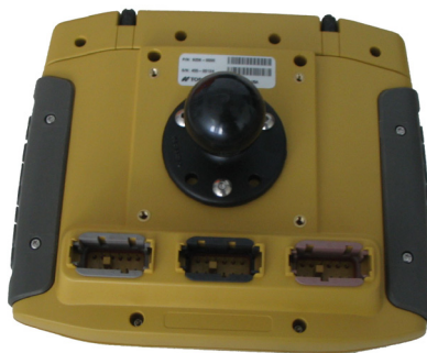
Figur 5-3. Kulfäste fastsatt på baksidan på System 110/150
