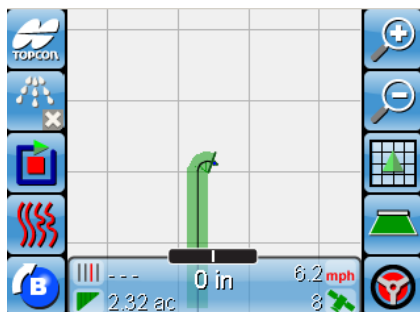
Figur 9-29. Gör en U-sväng för att markera slutet på en rad.
