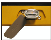
Figur F-4. USB-minnet satt inn på riktig måte
