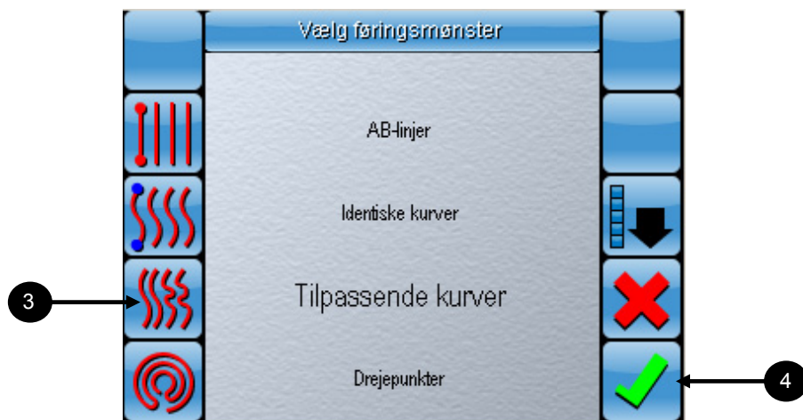
Figur 9-10. Vælg føringsmønsteret med tilpassende kurver
