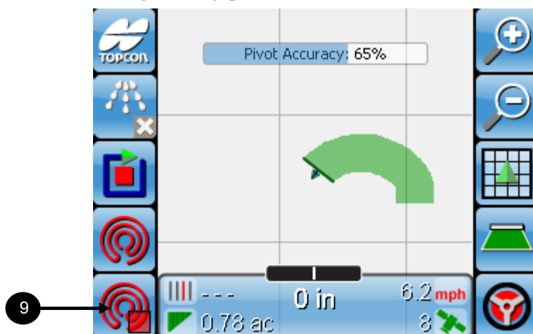
Figur 9-46. Begynd at køre, og aktiver beregning af drejepunktet
