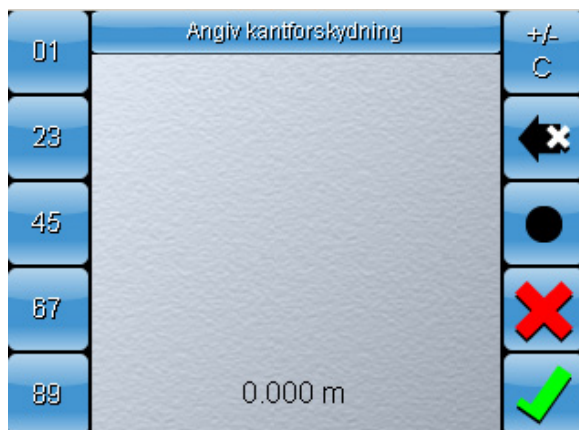
Figur 7-14. Indtast forskydningsværdien for kanten
