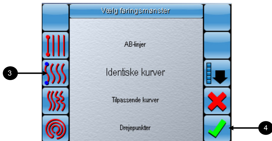
Figur 9-2. Vælg føringermønsteret med identiske kurver.
