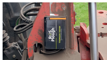
Positionsdata fås över ISOBUS från traktorns befintliga RTK autostyrning.
